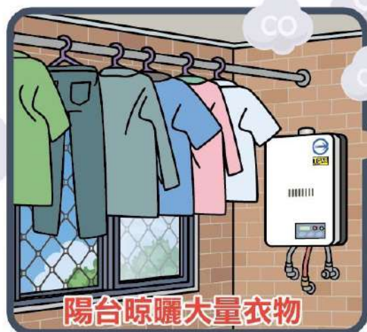
屋外式瓦斯熱水器 安裝在室內
